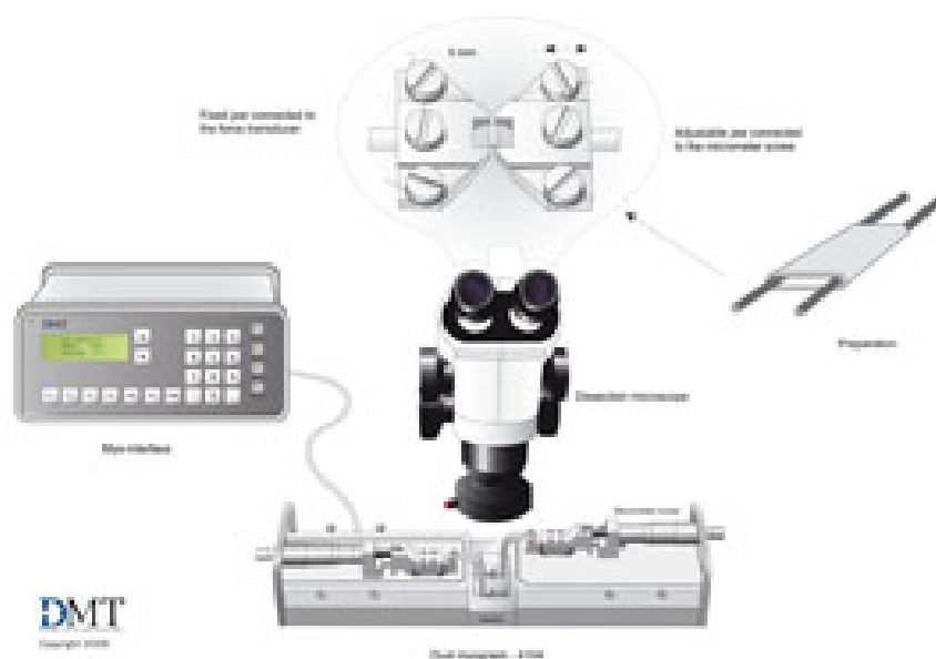
Схема 2. Схема на експериментална постановка за регистриране на изометрично съкращение на малки съдове с жичков миограф (model 300A, JP Trading, Denmark).
