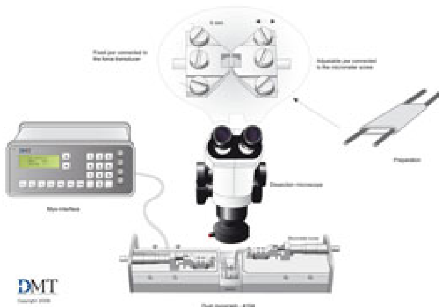
Схема 9. Схема на експериментална постановка за регистриране на изометрично съкращение на малки съдове с жичков миограф (model 300A, JP Trading, Denmark).
