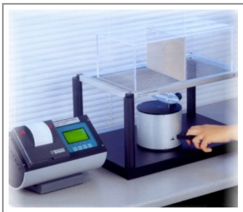
Фигура D4. Von Frey Test. При определена степен на натиск, животното отстранява съответната лапа, като в този момент апаратът отчита латенция (sec) и силата на натиск (g).
