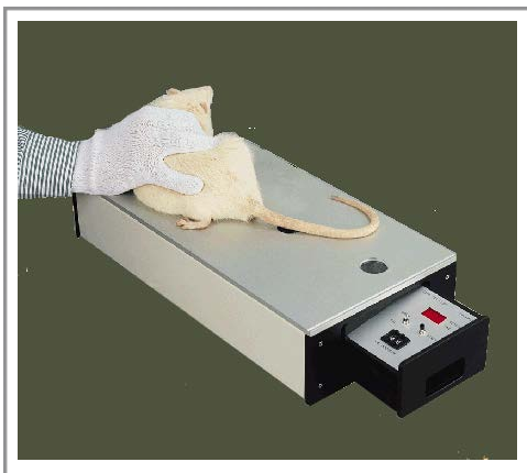
Фигура D6. Tail-Flick Test. Инфрачервеният лъч е фокусиран в областта проксимална/средна трета на опашката, като времето за което животното я отдръпва се отчита с таймер.
