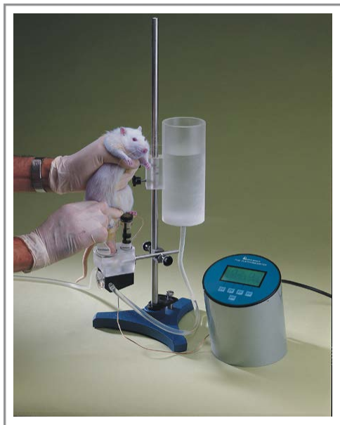
Фигура D3. Plethysmometer. Обема на лапата (ml) се отчита на базата на водоизместимостта.
