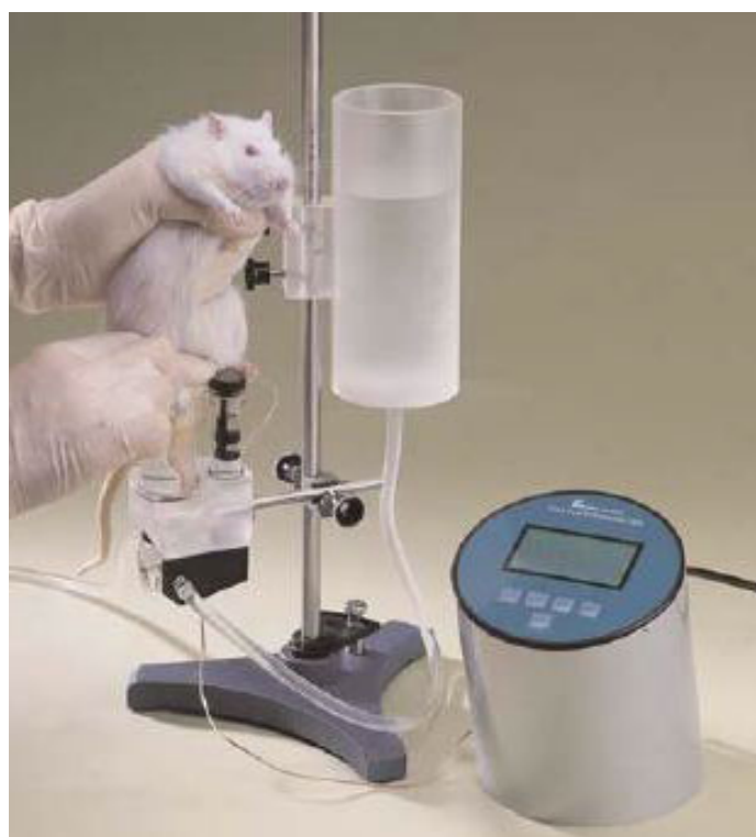
Снимка 1. Апарат плетизмометър за дигитално измерване на оток на лапа (Ugo Basile, Italy).
